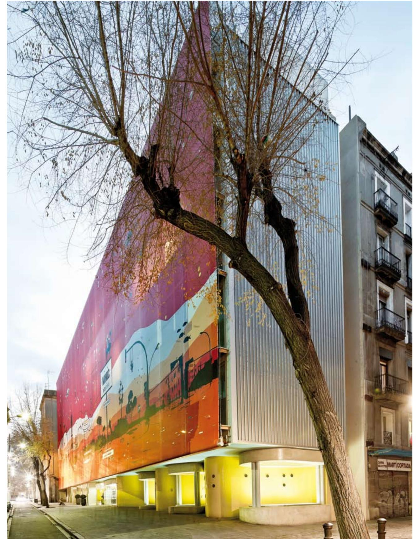
Una gran lona textil tensada recubre la fachada del hotel Arc del Teatre. Ha sido realizada por Serinkjet Comunicación Visual a partir de un diseño ideado por los autores del proyecto. Los maceteros son de Vondom. Como iluminación se han utilizado plafones de techo y apliques de pared 8551, de Limburg, con un tipo de protección IP 55.
