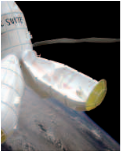
La estructura básica del hotel es modular, dado que las unidades individuales se deben transportar en un cohete espacial antes de ensamblarse en órbita. Cuatro de estos módulos cilíndricos se suman a un área central común. / The basic structure of the hotel is modular, since the individual units should be transported in a space rocket before being assembled in orbit. Four of these cylindrical modules are added to a common central area.
